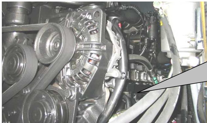
Rys. 16. Bagnet kontrolny poziomu oleju silnikowego
