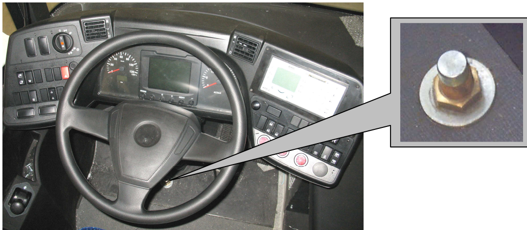
Rys. 12.1. Zawór pneumatyczny przestawiania kolumny kierownicy wraz z deską kierowcy
