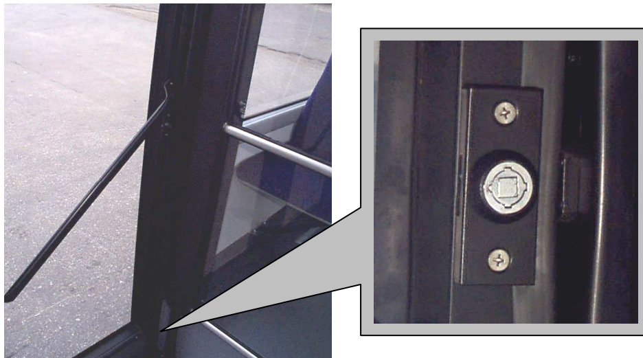
Rys. 24.3. Zamek kwadratowy blokowania drzwi od wewnątrz
