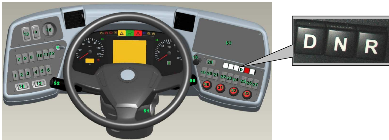
Rys. 4. Sterownik automatycznej skrzyni biegów : D – jazda do przodu, N – luz, R – jazda do tyłu (deska rozdzielcza kierowcy)
