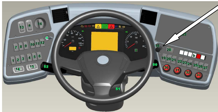
Rys. 8. Prawa strona deski kierowcy: dźwignia hamulca przystankowego (wskazana strzałką)
