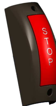
Rys. 24.6. Przycisk "stop" sygnalizuje kierowcy konieczność zatrzymania się na najbliższym przystanku
