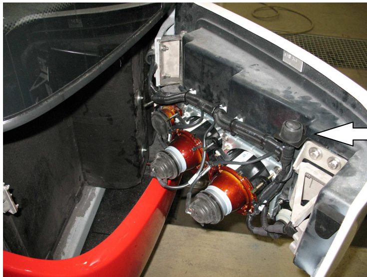
Rys. 15.28. Dostęp do przycisku otwierania 1-ch drzwi przez kierowcę z zewnątrz umiejscowiony w prawym skrzydle reflektorów (pokazany strzałką).
