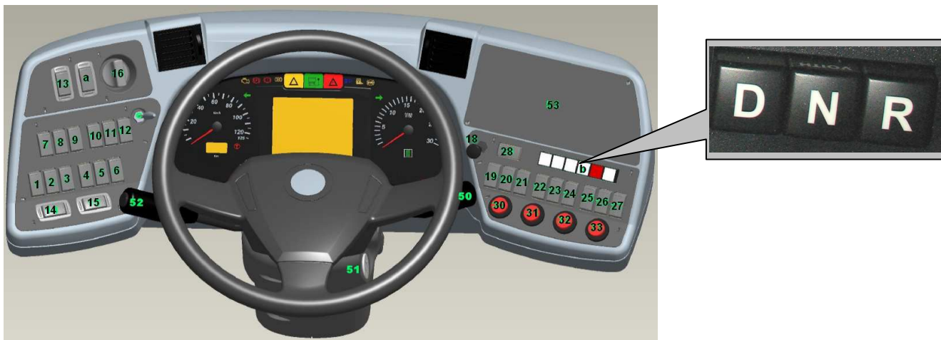
Rys. 5.1. Sterownik automatycznej skrzyni biegów (poz. b): D – jazda do przodu, N – luz, R – jazda do tyłu (deska rozdzielcza kierowcy)
