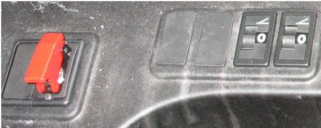
Rys. 18.3. Przełączniki sterowania kłap dachowych – wskazane strzałkami (pulpit kierowcy)
