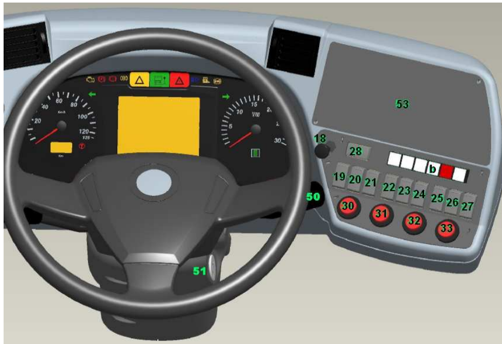
Rys. 24.7. Przyciski na prawej części deski kierowcy związane z obsługą drzwi:
