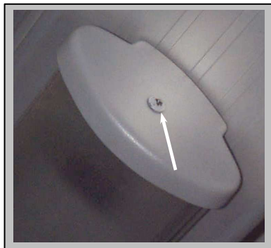
Rys. 15.19. Oświetlenie przedziału pasażerskiego – wkręt mocujący klosz lampy wskazany strzałką
