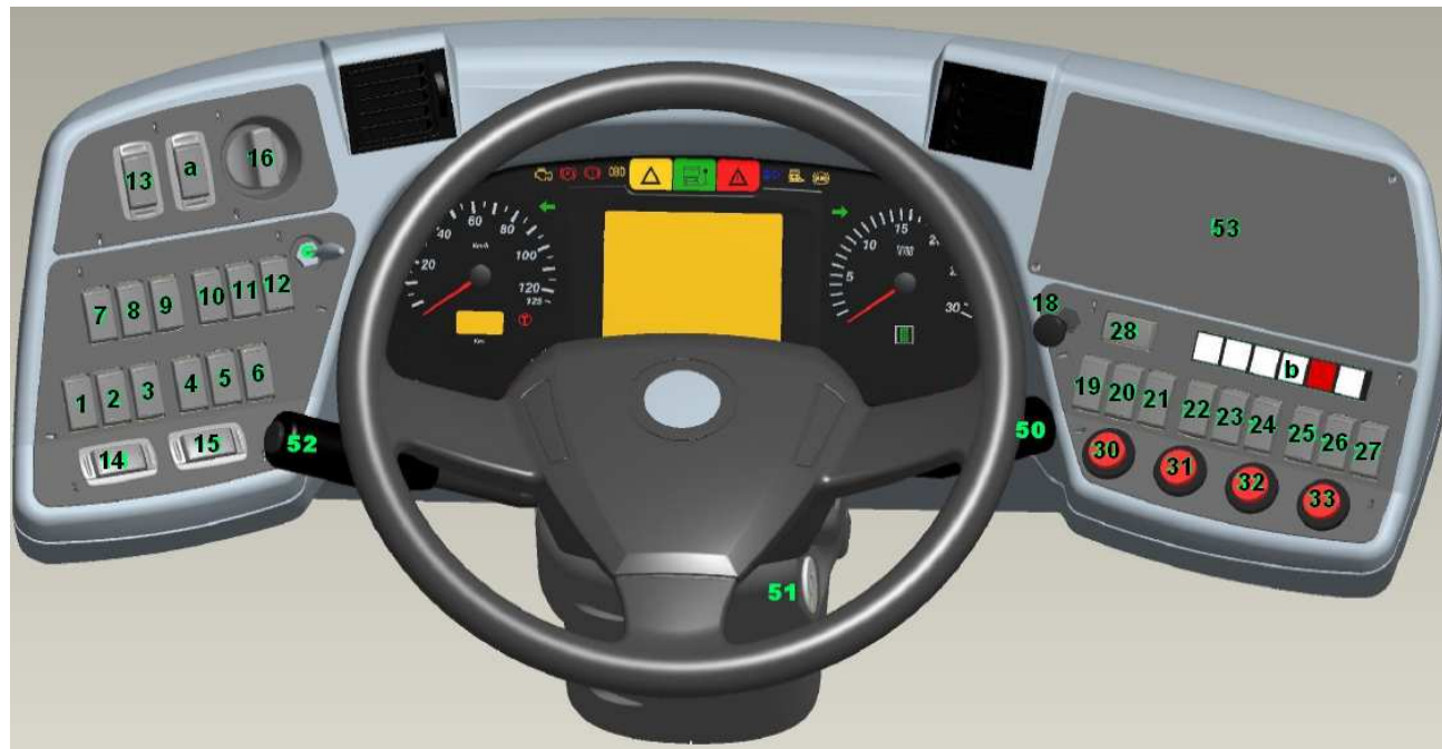
Rys. 15.8. Zespół przełączników znajdujących się na desce rozdzielczej kierowcy po lewej stronie
