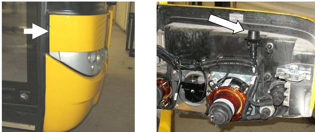
Rys. 24.2. Kłapa prawego reflektora oraz przycisk otwierania i zamykania pierwszego skrzydła przednich drzwi
