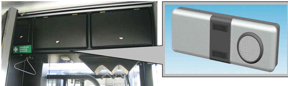
Rys. 15.20. Oświetlenie kabiny kierowcy
