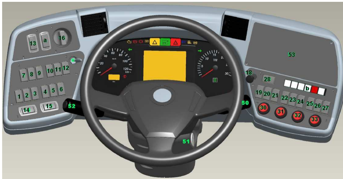
Rys. 15.7. Zespół przełączników znajdujących się na desce rozdzielczej kierowcy po prawej stronie
