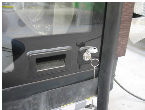
Rys. 24.1 Zamki patentowe pierwszego skrzydła przednich drzwi
